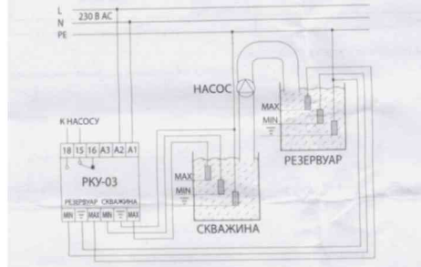
Рисунок 7. Схема подключения РКУ-03 к сети
