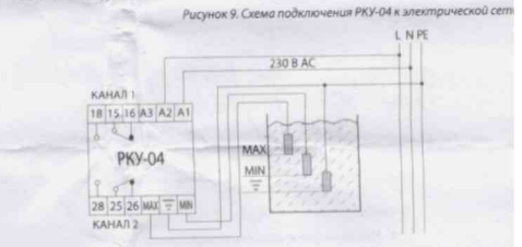
Рисунок 9. Схема подключения РКУ-04 к электрической сети
